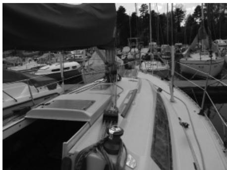
Le mât est rabattable (système Tom!). Le dessin de pont permet une bonne circulation. Le cockpit est sécurisant, car assez profond.
